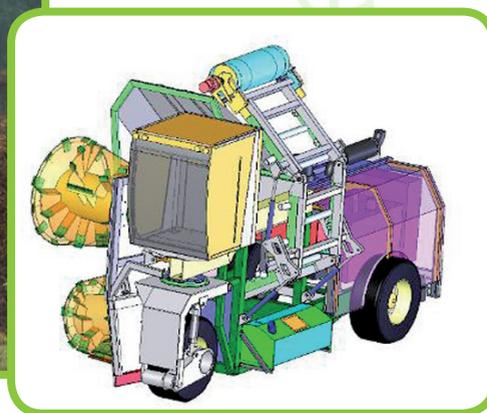
Les retourneurs Ménart bénéficient des technologies les plus élaborées, complètes et performantes. De plus, le design spécifique des rotors permet d'apporter une forte concentration d'oxygène dans les andains et assure un mélange optimal à chaque retournement.
