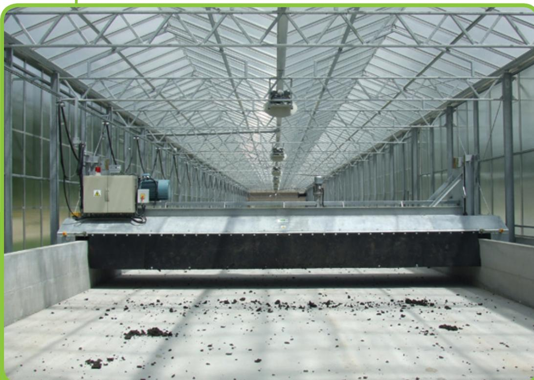
**M**ENART développe et équipe des unités de traitement de boues de stations d'épuration : retourneurs en couloir pour le séchage de boues, mélangeurs de boues avec des déchets verts couplés à un crible, broyeurs de déchets verts, etc.
