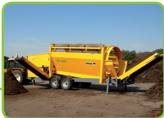
Une large gamme de tamis mobiles ou stationnaires permet de trouver la machine la plus efficace et la plus appropriée à chaque chantier. Tous les tamis Ménart adoptent le principe du tambour incliné; il est le plus adapté pour atteindre des rendements importants et présente un prix record en termes de coût d'exploitation.
